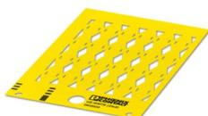
Targhetta per cavi, Scheda, giallo, in bianco, siglabile con: BLUEMARK ID COLOR, BLUEMARK ID, THERMOMARK PRIME, THERMOMARK CARD 2.0, THERMOMARK CARD, THERMOMARK PRIME 2.0, tipo di montaggio: Montaggio a fascette, diametro cavo: > 13 mm, Numero dei cartellini singoli: 24, altezza del campo di testo: 8 mm, larghezza del campo di testo: 29 mm
