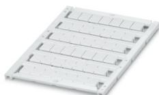
Segnamorsetti, Scheda, bianco, in bianco, siglabile con: BLUEMARK E.CARD, BLUEMARK ID COLOR, BLUEMARK ID, BLUEMARK CLED, THERMOMARK PRIME 2.0, THERMOMARK PRIME, THERMOMARK CARD 2.0, THERMOMARK CARD, TOPMARK NEO, TOPMARK LASER, tipo di montaggio: bloccaggio, per morsetti con spessore: 8,2 mm, Numero dei cartellini singoli: 42, altezza del campo di testo: 10,5 mm, larghezza del campo di testo: 7,6 mm
