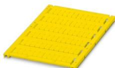
Segnamorsetti, Scheda, giallo, in bianco, siglabile con: BLUEMARK E.CARD, BLUEMARK ID COLOR, BLUEMARK ID, BLUEMARK CLED, THERMOMARK PRIME 2.0, THERMOMARK PRIME, THERMOMARK CARD 2.0, THERMOMARK CARD, TOPMARK NEO, TOPMARK LASER, tipo di montaggio: bloccaggio, per morsetti con spessore: 5,2 mm, Numero dei cartellini singoli: 72, altezza del campo di testo: 10,5 mm, larghezza del campo di testo: 4,6 mm
