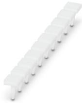
Nastro Zack per chiodini di siglatura, Striscia, bianco, in bianco, siglabile con: CMS-P1-PLOTTER, tipo di montaggio: Innesto, per morsetti con spessore: 5 mm, Numero dei cartellini singoli: 10, altezza del campo di testo: 4 mm, larghezza del campo di testo: 4 mm
