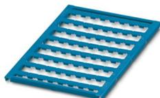
Segnamorsetti, Scheda, blu, in bianco, siglabile con: BLUEMARK E.CARD, BLUEMARK ID COLOR, BLUEMARK ID, BLUEMARK CLED, PLOTMARK, CMS-P1-PLOTTER, tipo di montaggio: bloccaggio, per morsetti con spessore: 8 mm, Numero dei cartellini singoli: 64, altezza del campo di testo: 5,2 mm, larghezza del campo di testo: 7,65 mm
