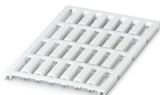
Segnaconduttori, Scheda, bianco, in bianco, siglabile con: BLUEMARK E.CARD, BLUEMARK ID COLOR, BLUEMARK ID, BLUEMARK CLED, PLOTMARK, CMS-P1-PLOTTER, diametro cavi: 3,6 ... 4,9 mm, tipo di montaggio: infilamento, Numero dei cartellini singoli: 24, altezza del campo di testo: 5 mm, larghezza del campo di testo: 21 mm
