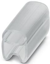
Portacartellini per conduttori, trasparente, in bianco, diametro cavi: 1,5 ... 2,5 mm, tipo di montaggio: infilamento, altezza del campo di testo: 4 mm, larghezza del campo di testo: 12 mm
