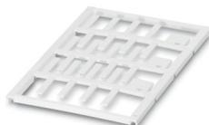
Segnaconduttori, Scheda, bianco, in bianco, siglabile con: BLUEMARK E.CARD, BLUEMARK ID COLOR, BLUEMARK ID, BLUEMARK CLED, PLOTMARK, CMS-P1-PLOTTER, diametro cavi: 0,6 ... 22 mm, tipo di montaggio: inserire, Numero dei cartellini singoli: 24, altezza del campo di testo: 4 mm, larghezza del campo di testo: 18 mm
