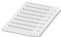
Segnamorsetti, Scheda, bianco, in bianco, siglabile con: BLUEMARK E.CARD, BLUEMARK ID COLOR, BLUEMARK ID, BLUEMARK CLED, PLOTMARK, CMS-P1-PLOTTER, tipo di montaggio: bloccaggio, per morsetti con spessore: 5,2 mm, Numero dei cartellini singoli: 80, altezza del campo di testo: 7 mm, larghezza del campo di testo: 5 mm
