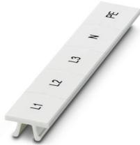
Nastro Zack, Striscia, bianco, siglato, siglatura longitudinale: L1, L2, L3, N, PE, tipo di montaggio: bloccaggio, per morsetti con spessore: 12,2 mm, Numero dei cartellini singoli: 5, altezza del campo di testo: 10,5 mm, larghezza del campo di testo: 12,15 mm
