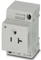
Presa di corrente, con LED, Tipo: AB 20A, tipo di connessione: Connessione a vite, colore: grigio, tensione nominale: 125 V AC (60 Hz), corrente nominale: 20 A, per montaggio su guida di montaggio nell'interfaccia di servizio o per montaggio diretto, norme/disposizioni: UL 508, IEC 60884-1, Contrassegno del paese: USA, Canada
