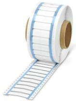
Guaina termoretraibile, Rotolo, bianco, in bianco, siglabile con: THERMOMARK E.300 (D)/600 (D), THERMOMARK ROLLMASTER 300/600, THERMOMARK ROLL X1, THERMOMARK ROLL, THERMOMARK ROLL 2.0, THERMOMARK W, THERMOMARK X1.2, diametro cavi: 3,2 ... 9,5 mm, perforato, tipo di montaggio: infilamento, Numero dei cartellini singoli: 2000, altezza del campo di testo: 16 mm, larghezza del campo di testo: 30 mm
