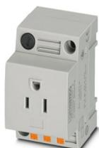
Preso di corrente, con fusibile 5 x 20 mm, 6,3 A, Piano d'inserimento tipo AB 15A, tipo di connessione: Connessione a molla Push-in, colore: grigio, tensione nominale: 125 V AC (60 Hz), corrente nominale: 6 A, per montaggio su guida di montaggio nell'interfaccia di servizio o per montaggio diretto, norme/disposizioni: UL 508, IEC 60884-1, Contrassegno del paese: USA, Canada
