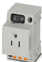
Presa di corrente, con interruttore, Piano d'inserimento tipo AB 15A, tipo di connessione: Connessione a molla Push-in, colore: grigio, tensione nominale: 125 V AC (60 Hz), corrente nominale: 15 A, Montaggio su guida DIN o diretto, norme/disposizioni: UL 508, IEC 60884-1, Contrassegno del paese: USA, Canada
