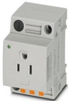
Presa di corrente, con spia luminosa, fusibile 5 x 20 mm, 6,3 A, Piano d'inserimento tipo AB 15A, tipo di connessione: Connessione a molla Push-in, colore: grigio, tensione nominale: 125 V AC (60 Hz), corrente nominale: 6 A, per montaggio su guida di montaggio nell'interfaccia di servizio o per montaggio diretto, norme/disposizioni: UL 508, IEC 60884-1, Contrassegno del paese: USA, Canada
