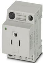
Presa di corrente, con spia luminosa, fusibile 5 x 20 mm, 6,3 A, Piano d'inserimento tipo AB 15A, tipo di connessione: Connessione a vite, colore: grigio, tensione nominale: 125 V AC (60 Hz), corrente nominale: 6 A, per montaggio su guida di montaggio nell'interfaccia di servizio o per montaggio diretto, norme/disposizioni: UL 508, IEC 60884-1, Contrassegno del paese: USA, Canada
