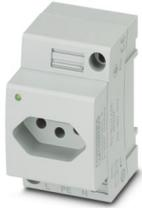
Presa di corrente, con LED, Piano d'inserimento tipo N, tipo di connessione: Connessione a vite, colore: grigio, tensione nominale: 250 V AC (50 Hz ... 60 Hz), corrente nominale: 20 A, per montaggio su guida di montaggio nell'interfaccia di servizio o per montaggio diretto, Contrassegno del paese: Brasile
