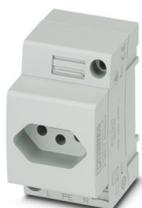
Presa di corrente, per Brasile / Sudafrica e altri paesi, Piano d'inserimento tipo N, tipo di connessione: Connessione a vite, colore: grigio, tensione nominale: 250 V AC (50 Hz ... 60 Hz), corrente nominale: 20 A, per montaggio su guida di montaggio nell'interfaccia di servizio o per montaggio diretto, Contrassegno del paese: Brasile
