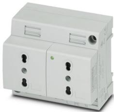
Presa doppia, con protezione da contatto diretto estesa / shutter, spia luminosa, Piano d'inserimento tipo L, tipo di connessione: Connessione a vite, colore: grigio, tensione nominale: 250 V AC (50 Hz), corrente nominale: 16 A, Montaggio su guida DIN o diretto, norme/disposizioni: CEI 23-50, Contrassegno del paese: Italia
