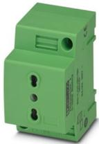
Presa di corrente, con protezione da contatto diretto estesa / shutter, Piano d'inserimento tipo L, tipo di connessione: Connessione a vite, colore: verde, tensione nominale: 250 V AC (50 Hz), corrente nominale: 16 A, per montaggio su guida di montaggio nell'interfaccia di servizio o per montaggio diretto, norme/disposizioni: CEI 23-50, Contrassegno del paese: Italia
