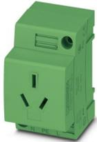
Presa di corrente, per Cina e altri paesi, Piano d'inserimento tipo I, tipo di connessione: Connessione a vite, colore: verde, tensione nominale: 250 V AC (50 Hz), corrente nominale: 10 A, per montaggio su guida di montaggio nell'interfaccia di servizio o per montaggio diretto, norme/disposizioni: GB 2099.1 e GB 1002, Contrassegno del paese: Cina
