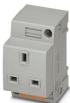
Presa di corrente, con protezione da contatto diretto estesa / shutter, Piano d'inserimento tipo G, tipo di connessione: Connessione a molla Push-in, colore: grigio, tensione nominale: 250 V AC (50 Hz), corrente nominale: 13 A, per montaggio su guida di montaggio nell'interfaccia di servizio o per montaggio diretto, norme/disposizioni: BS 1363-2, Contrassegno del paese: Gran Bretagna
