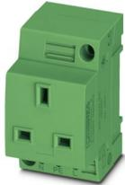
Presa di corrente, con protezione da contatto diretto estesa / shutter, Piano d'inserimento tipo G, tipo di connessione: Connessione a vite, colore: verde, tensione nominale: 250 V AC (50 Hz), corrente nominale: 13 A, per montaggio su guida di montaggio nell'interfaccia di servizio o per montaggio diretto, norme/disposizioni: BS 1363-2, Contrassegno del paese: Gran Bretagna
