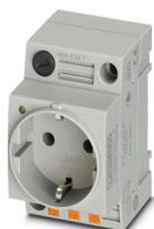
Presa di corrente, con fusibile 5 x 20 mm, 6,3 A, Piano d'inserimento tipo CF, tipo di connessione: Connessione a molla Push-in, colore: grigio, tensione nominale: 250 V AC (50 Hz), corrente nominale: 6 A, per montaggio su guida di montaggio nell'interfaccia di servizio o per montaggio diretto, norme/disposizioni: VDE 0620-1, IEC 60884-1, Contrassegno del paese: Germania
