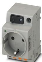
Presa di corrente, con spia luminosa, interruttore, Piano d'inserimento tipo CF, tipo di connessione: Connessione a molla Push-in, colore: grigio, tensione nominale: 250 V AC (50 Hz), corrente nominale: 16 A, Montaggio su guida DIN o diretto, norme/disposizioni: VDE 0620-1, IEC 60884-1, Contrassegno del paese: Germania
