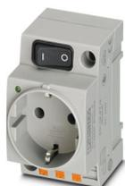
Presa di corrente, con interruttore, Piano d'inserimento tipo CF, tipo di connessione: Connessione a molla Push-in, colore: grigio, tensione nominale: 250 V AC (50 Hz), corrente nominale: 16 A, Montaggio su guida DIN o diretto, norme/disposizioni: VDE 0620-1, IEC 60884-1, Contrassegno del paese: Germania
