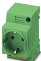
Presa di corrente, con LED, Piano d'inserimento tipo CF, tipo di connessione: Connessione a molla Push-in, colore: verde, tensione nominale: 250 V AC (50 Hz), corrente nominale: 16 A, per montaggio su guida di montaggio nell'interfaccia di servizio o per montaggio diretto, norme/disposizioni: VDE 0620-1, IEC 60884-1, Contrassegno del paese: Germania
