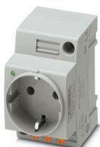
Preso di corrente, con LED, Piano d'inserimento tipo CF, tipo di connessione: Connessione a molla Push-in, colore: grigio, tensione nominale: 250 V AC (50 Hz), corrente nominale: 16 A, per montaggio su guida di montaggio nell'interfaccia di servizio o per montaggio diretto, norme/disposizioni: VDE 0620-1, IEC 60884-1, Contrassegno del paese: Germania
