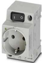
Presa di corrente, con spia luminosa, interruttore, Piano d'inserimento tipo CF, tipo di connessione: Connessione a vite, colore: grigio, tensione nominale: 250 V AC (50 Hz), corrente nominale: 16 A, Montaggio su guida DIN o diretto, norme/disposizioni: VDE 0620-1, IEC 60884-1, Contrassegno del paese: Germania
