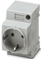
Presa di corrente, Piano d'inserimento tipo CF, tipo di connessione: Connessione a vite, colore: grigio, tensione nominale: 250 V AC (50 Hz), corrente nominale: 16 A, per montaggio su guida di montaggio nell'interfaccia di servizio o per montaggio diretto, norme/disposizioni: VDE 0620-1, IEC 60884-1, Contrassegno del paese: Germania
