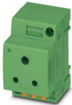
Presa di corrente, con LED, Tipo: D, tipo di connessione: Connessione a molla Push-in, colore: verde, tensione nominale: 250 V AC (50 Hz), corrente nominale: 6 A, per montaggio su guida di montaggio nell'interfaccia di servizio o per montaggio diretto, Contrassegno del paese: India / Africa
