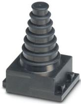
Isolatori passanti, grandi, numero dei conduttori: 1, esecuzione: Cavo a sezione circolare, chiuso, diametro esterno conduttore: 1x 7 mm ... 24 mm, materiale: NBR, colore: nero, lunghezza: 29,5 mm, larghezza: 19,5 mm, altezza: 17 mm
