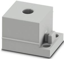
Isolatori passanti, piccoli, numero dei conduttori: 1, esecuzione: Cavo a sezione circolare, intagliato, diametro esterno conduttore: 1x 8 mm ... 9 mm, materiale: SEBS (senza alogenati), colore: grigio, lunghezza: 29,5 mm, larghezza: 19,5 mm, altezza: 17 mm
