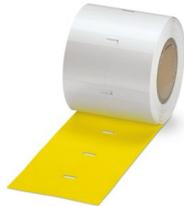
Cartellino a stecca, per la siglatura della serie Axioline F di Phoenix Contact, Rotolo, giallo, in bianco, siglabile con: THERMOMARK E.300 (D)/600 (D), THERMOMARK ROLL 2.0, THERMOMARK ROLL, THERMOMARK ROLL X1, THERMOMARK ROLLMASTER 300/600, THERMOMARK X1.2, tipo di montaggio: inserire, Numero dei cartellini singoli: 500, altezza del campo di testo: 28 mm, larghezza del campo di testo: 35 mm
