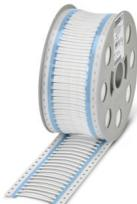
Guaina termoretraibile, Rotolo, bianco, in bianco, siglabile con: THERMOMARK E.300 (D)/600 (D), THERMOMARK ROLLMASTER 300/600, THERMOMARK ROLL X1, THERMOMARK ROLL, THERMOMARK ROLL 2.0, THERMOMARK W, THERMOMARK X1.2, diametro cavi: 0,8 ... 2,4 mm, perforato, tipo di montaggio: infilamento, Numero dei cartellini singoli: 10000, altezza del campo di testo: 4 mm, larghezza del campo di testo: 15 mm
