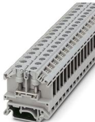
Morsetto universale con attacco a capocorda, sezione: 0,1 -2,5 mm<sup>2</sup>, spessore: 9 mm, colore: grigio
