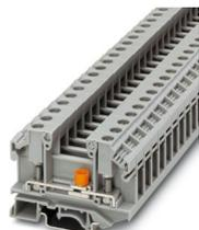
Morsetto sezionatore, con dispositivo di separazione e viti per prese di prova per l'alloggiamento di spine di prova, tensione nominale: 800 V, corrente nominale: 36 A, tipo di connessione: Bullone, Sezione di dimensionamento: 6 mm<sup>2</sup>, montaggio: NS 35/7,5, NS 35/15, NS 32, colore: grigio
