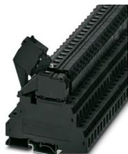
Morsetto portafusibili, tipo di fusibile: Vetro / ceramica / ..., tipo fusibile: G / 5 x 20, tensione nominale: 400 V, corrente nominale: 32 A, tipo di connessione: Connessione a vite, Sezione di dimensionamento: 1,5 mm<sup>2</sup>, sezione: 0,2 mm<sup>2</sup>- 4 mm<sup>2</sup>, tipo di montaggio: NS 35/7,5, NS 35/15, NS 32, colore: nero
