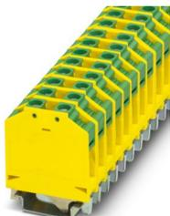
Mors. univ. per cond. di terra con attacco a capocorda, sez.: 0,1 - 6 mm<sup>2</sup>, largh.: 11 mm, colore: verde-giallo, variante realizzata appositamente per le guide di supporto NS 35/15-2,3 e NS 35/15-AL
