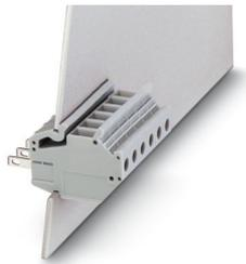
Morsetto d'esecuzione, tipo di connessione: Connessione a vite con gabbia, Morsetti a saldare/con attacco Faston, numero poli: 1, corrente di carico: 18 A, sezione: 0,2 mm<sup>2</sup> - 6 mm<sup>2</sup>, direzione di connessione del conduttore alla direzione di inserzione: 90 °, larghezza: 6,15 mm, colore: grigio
