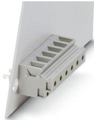
Morsetto d'esecuzione, tipo di connessione: Connessione a vite con gabbia, Morsetti a saldare/con attacco Faston, numero poli: 1, corrente di carico: 18 A, sezione: 0,2 mm<sup>2</sup> - 6 mm<sup>2</sup>, direzione di connessione del conduttore alla direzione di inserzione: 90 °, larghezza: 38 mm, colore: grigio
