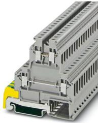
Morsetto a due piani, tensione nominale: 500 V, corrente nominale: 30 A, tipo di connessione: Connessione a vite, 1. e 2. piano, Sezione di dimensionamento: 4 mm<sup>2</sup>, sezione: 0,2 mm<sup>2</sup> - 4 mm<sup>2</sup>, tipo di montaggio: NS 35/7,5, NS 35/15, colore: grigio
