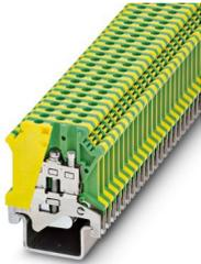
Morsetti comp. per conduttori terra, In caso di affiancamento con morsetti passanti dal profilo identico, in presenza di tensioni di isolamento 690 V, occorre impiegare una piastra terminale., numero di connessioni: 2, numero poli: 1, tipo di connessione: Connessione a vite, Sezione di dimensionamento: 4 mm<sup>2</sup>, sezione: 0,2 mm<sup>2</sup> - 4 mm<sup>2</sup>, tipo di montaggio: NS 35/15-2,3, colore: giallo-verde
