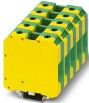
Morsetti comp. per conduttori terra, con viti ad esagono cavo, numero di connessioni: 2, numero poli: 1, tipo di connessione: Connessione a vite, Sezione di dimensionamento: 50 mm<sup>2</sup>, sezione: 16 mm<sup>2</sup> - 50 mm<sup>2</sup>, tipo di fissaggio: Piedino PE con vite di fissaggio M6, tipo di montaggio: NS 35/7,5, NS 35/15, NS 32, colore: giallo-verde
