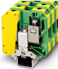
Morsetti comp. per conduttori terra, numero di connessioni: 2, numero poli: 1, tipo di connessione: Connessione a vite, Sezione di dimensionamento: 50 mm<sup>2</sup>, sezione: 16 mm<sup>2</sup> - 50 mm<sup>2</sup>, tipo di fissaggio: Piedino PE con vite di fissaggio M6, tipo di montaggio: NS 35/7,5, NS 35/15, NS 32, colore: giallo-verde
