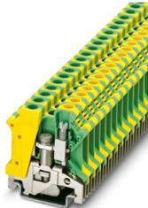
Morsetti comp. per conduttori terra, numero di connessioni: 2, tipo di connessione: Connessione a vite, sezione: 0,2 mm<sup>2</sup> - 10 mm<sup>2</sup>, tipo di fissaggio: Piedino PE con vite di fissaggio M4, tipo di montaggio: NS 35/7,5, NS 35/15, NS 32, colore: giallo-verde
