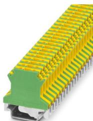
Morsetti comp. per conduttori terra, numero di connessioni: 2, numero poli: 1, tipo di connessione: Connessione a vite, sezione: 0,2 mm<sup>2</sup> - 4 mm<sup>2</sup>, tipo di fissaggio: Piedino PE con vite di fissaggio M3, tipo di montaggio: NS 35/7,5, NS 35/15, NS 32, colore: giallo-verde
