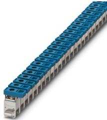
Morsetto di collegamento, tensione nominale: 300 V, corrente nominale: 125 A, tipo di connessione: Connessione a vite, Sezione di dimensionamento: 35 mm<sup>2</sup>, sezione: 2,5 mm<sup>2</sup> - 35 mm<sup>2</sup>, montaggio: Barra colletttrice N, colore: blu
