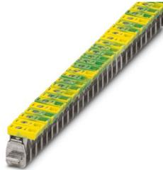
Morsetto di collegamento, tensione nominale: 300 V, corrente nominale: 76 A, tipo di connessione: Connessione a vite, Sezione di dimensionamento: 16 mm<sup>2</sup>, sezione: 1,5 mm<sup>2</sup> - 16 mm<sup>2</sup>, montaggio: Barra colletttrice N, colore: giallo-verde
