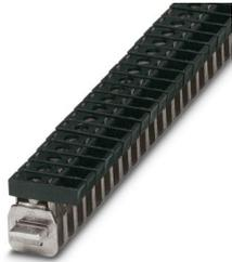
Morsetto di collegamento, tensione nominale: 300 V, corrente nominale: 32 A, tipo di connessione: Connessione a vite, Sezione di dimensionamento: 4 mm<sup>2</sup>, sezione: 0,5 mm<sup>2</sup> - 6 mm<sup>2</sup>, montaggio: Barra colletttrice N, colore: nero
